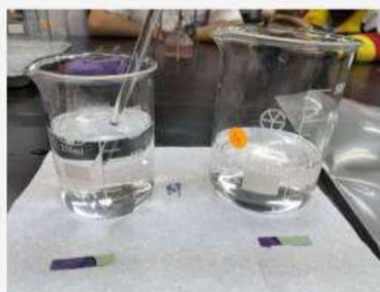
使用廣用試紙檢測氫氧化鈉水溶液的酸鹼
